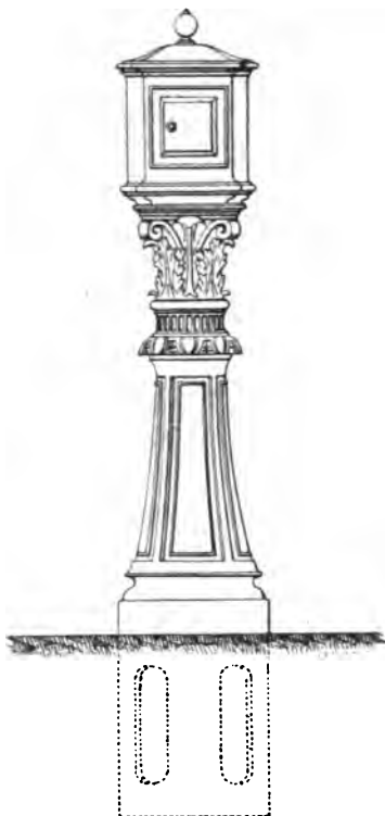
FIG. 557. — Poste de charge.
